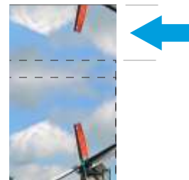
Diesen Bereich nennt man im Fachjargon: "Hohlraum flachliegend". Es handelt sich bei dieser Angabe um den Teil, der hinter das sichtbare Motiv geklappt wird. (Ohne Naht) Bsp.: Sie möchten ein 5 cm Rohr durch den Hohlraum schieben. Benötigt wird ein Hohlraum 10 cm flachliegend. (in Wirklichkeit 13 cm wegen der Naht)
